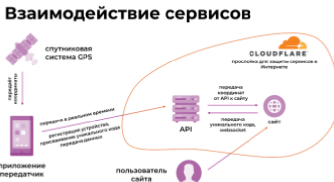
Рисунок 2 – Схема взаимодействия сервисов приложения
