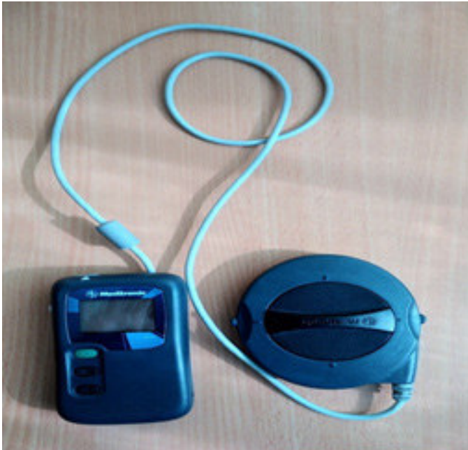
Рисунок 1. Программное устройство для имплантируемых нейростимуляторов для глубокой стимуляции головного мозга DBS.
