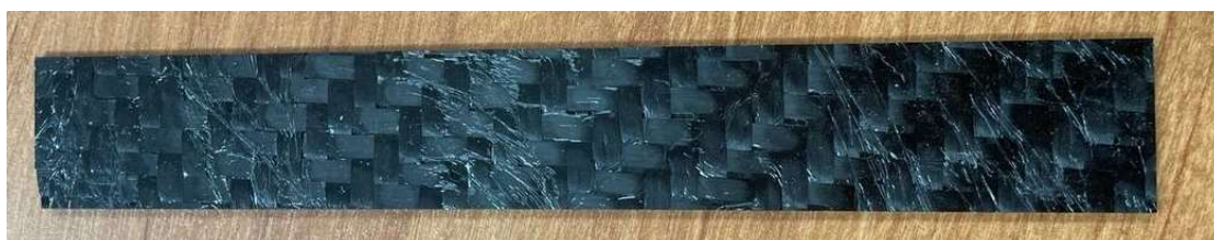
Рисунок 2 – Образец, полученный методом вакуумной инфузии
