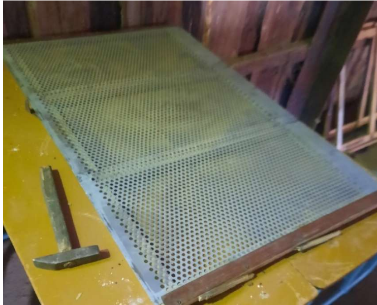
Рисунок 1 – Верхнее решето для отчистки и сортирования семян сои
