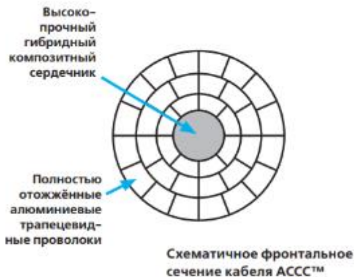
Рисунок 1 – Провод АССС в разрезе
