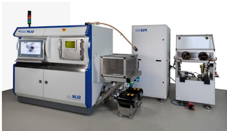
Рисунок 1 - SLM-принтер со станцией просеивания порошка и герметичным боксом для очистки от порошка
