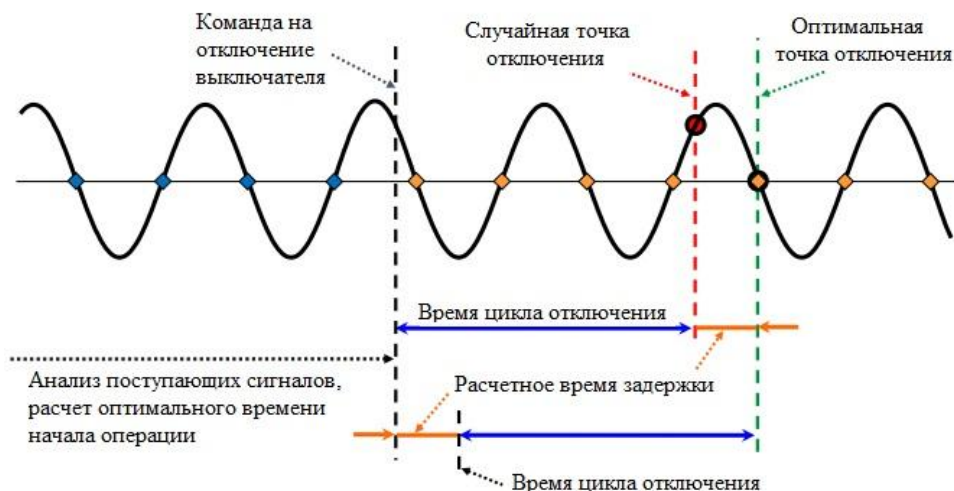
Рисунок 1 – Работа выключателя в управляемом и неуправляемом режиме
