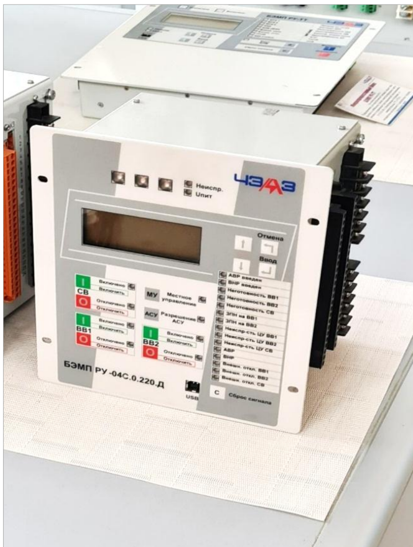
Рисунок 1 – Микропроцессорный терминал БЭМП РУ
