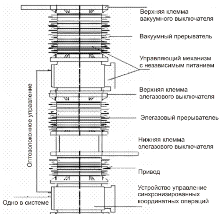
Рисунок 1. Структурное представление гибридного выключателя
